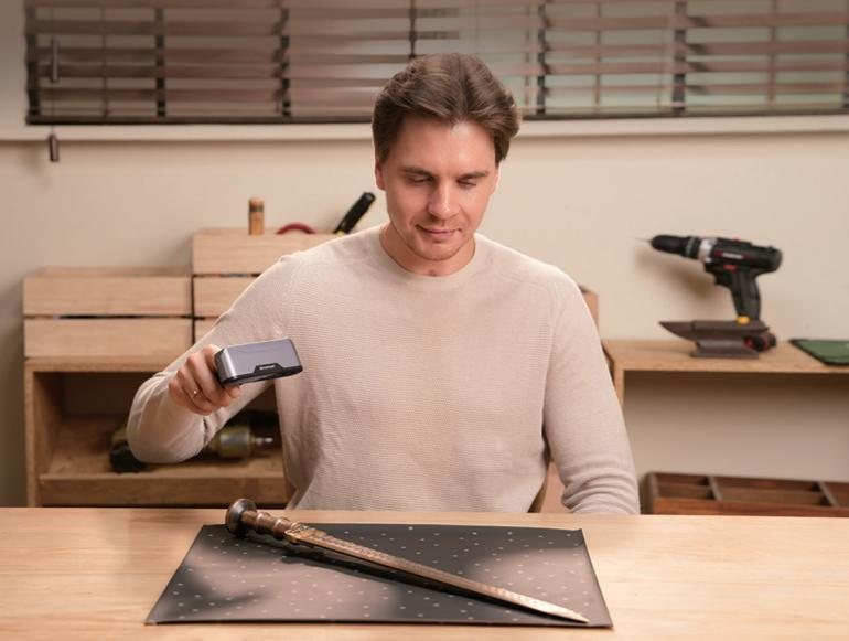
INSPIRE 依然延续 Revopoint 扫描仪机身轻巧的设计理念,搭载了智能算法系统和 9 轴陀螺仪装置,使拼接超丝滑。采用一级红外光与 RGB、LED 补光照明设计,可适应不同扫描对象和场景,输出高品质三维模型,更将易用、性价比集于一身,全方位革新入门级扫描体验。
